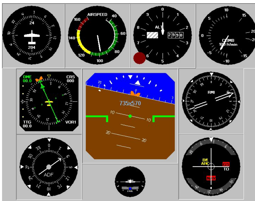
Fig. 6: Interfaccia grafica del pannello strumenti.
