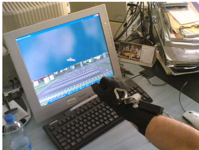
Figura 7 Esempio di pilotaggio con il guanto all'interno del simulatore.
